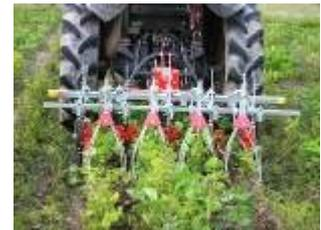
図 1 狭畦栽培での機械除草 (K 社製麦用除草機)
