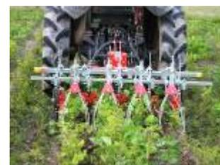
図 1 狭条栽培での機械除草
