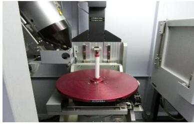
図 2 X線 CT 装置による子実内部の測定
