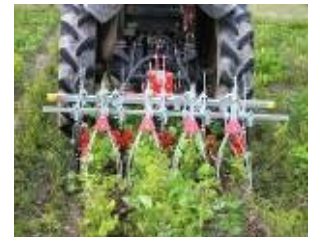
図1 狭畦栽培での機械除草 (K社製麦用除草機を検討)
