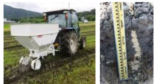
図2 疎水材心土充填機(左)と籾殻充填暗渠(右)
