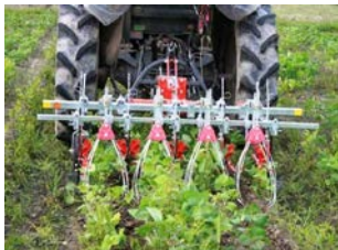
図1 狭畦栽培での機械除草 (K社製麦用除草機を検討)
