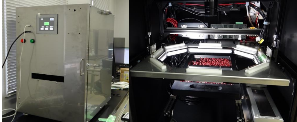
図3 検査装置の原理試作機（子実片面撮影）と装置内部
