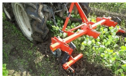
写真2 小豆の畝をまたぎ、トラクタが畦間サブソイラ (A農機 KKSA-3) を牽引している様子
