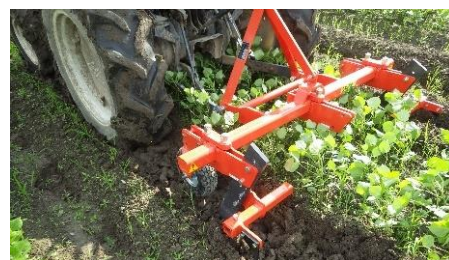
写真3 小豆の畝をまたぎ、トラクタが畦間サブソイラ (A 農機 KKSA-3) を牽引している様子
