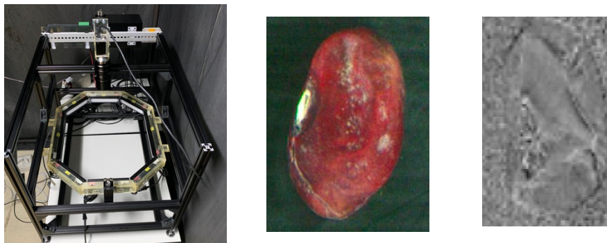
図4 フォトメトリックステレオ撮像装置(左) 凹みのある大正金時(中央)、 フォトメトリックステレオで得られた平面曲率画像(右)
