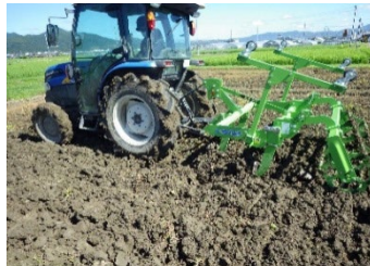
写真 2 チゼルプラウをトラクタ で牽引している様子
