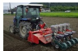
写真③ アップカットロータリ 耕深約 15cm
