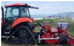
写真① 浅耕播種機 耕深約 8cm
