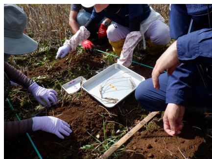
図7 ヘッドロス調査（刈取部で地上に落ちた子実、莢や刈残しの回収）
