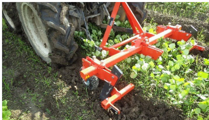
小豆の畝をまたぎ、トラクタが畦間サブソイラ (A農機KKSA-3)を牽引している様子
