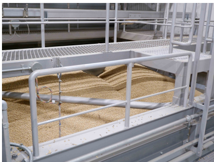
豆の貯留タンクは「豆のプール」／最上部
