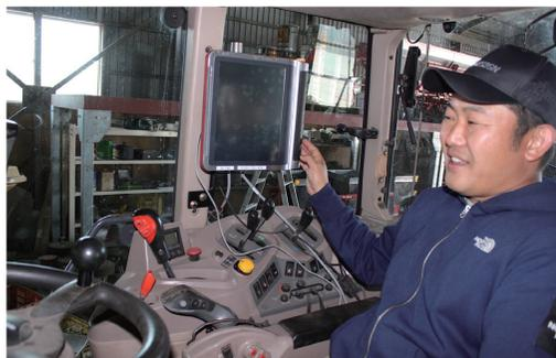
GPSガイダンスの自動操舵システムを設置したトラクター内。経営面積が広い更別村ではこうした最新機器を導入する農家が増えている
