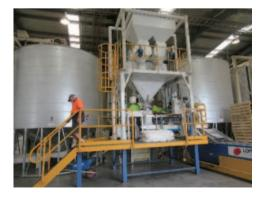
選別、包装工場で、カンガルー島のbroadbeansを中心に、ヒヨコ豆などを扱っている。今は、カノーラ、小麦、大麦を出している。バルク製品はそのまま出すが、洗浄システムがあるので、バルク以外でも扱う。入荷したコンテナから、サイロに貯めて、洗浄して、ふるいで選別する。検査員のチェックを受けて、パッキングして、コンテナに積む。バルクサイロは6~7日で外へ出す。
