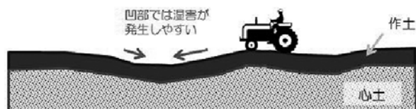
図5-3 傾斜均平化によるほ場づくりのイメージ
