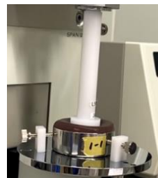
図 3 クリープメータによる物性測定
