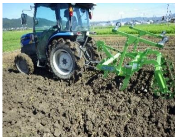
写真2 チゼルプラウをトラクタで牽引している様子
