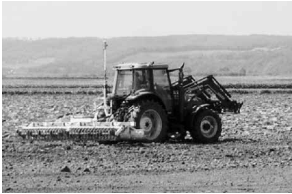
写真5-3 レーザー均平機の施工
