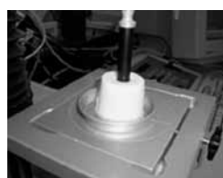
テクスチャーアナライザーによる豆腐の硬さ(破断応力)の測定
