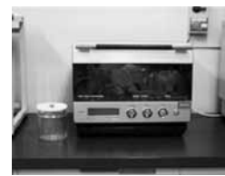
具を加熱するための容器とスチーム機能付き電子レンジ 具: 大豆を水で浸漬後に破碎したもの
