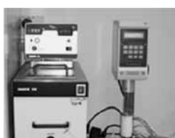
回転式粘度計による豆乳粘度の測定
